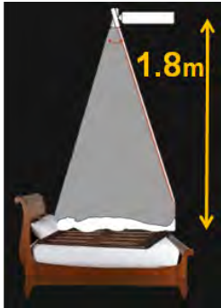
<그림 1> 수면 자세 인식을 위한 전체 시스템 구성도
