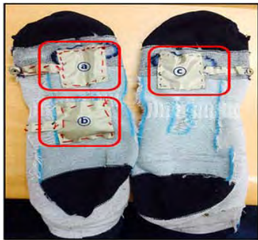
그림 3. 양말에 전도성 섬유를 부착한 모습 (a) VIN+, (b) GND, (c) VIN-
