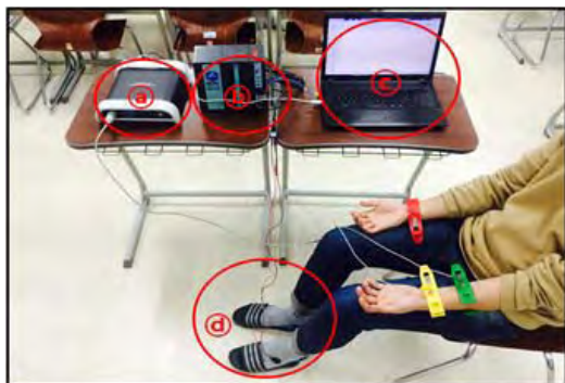
그림 4. 심전도 측정 모습 (a) E2-KIT, (b) BIOPAC, (c) 심전도 모니터링, (d) 전도성 섬유 전극
