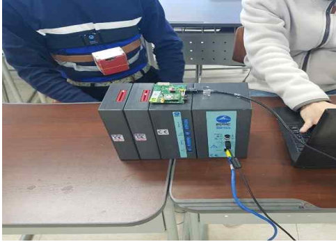
〈그림 3〉 섬유 압력센서와 MP150의 호흡 측정 실험
