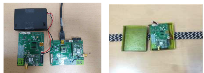
〈그림 2〉 섬유 압력센서 측정모듈 및 모듈케이스
